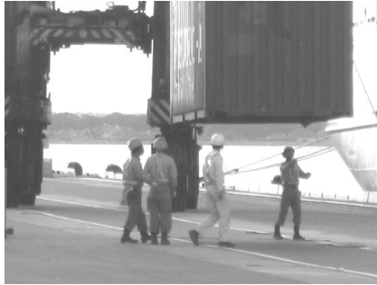
② ヤードからの移動 ストラドルキャリアでの移動。
